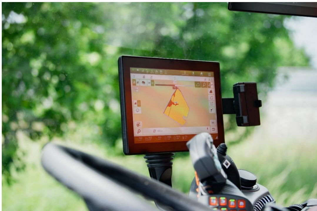
Prikaz mape ciljnega gnojenja njivske površine na zaslonu traktorskega terminala (FOTO: ITC Murska Sobota).
